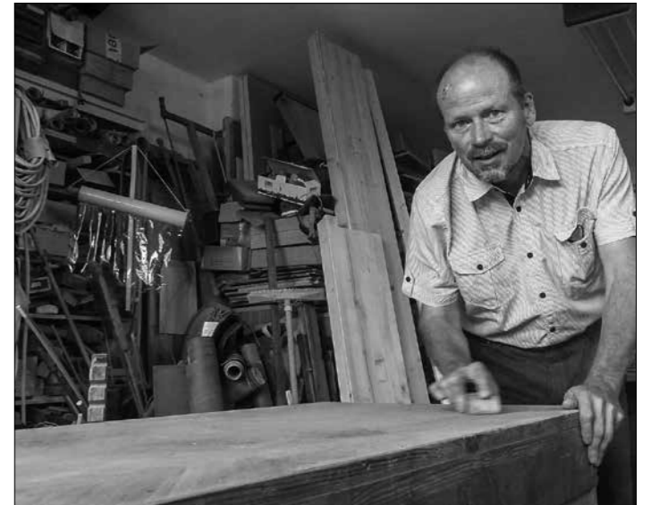
Auch das gehört dazu: langwieriges Schleifen. Bei diesem Schreibtisch von 1880 mußte das Nussbaumfurnier auf der Schreibfläche völlig ersetzt werden. Die kaputte Platte war mit einer Spanplatte abgedeckt gewesen..
